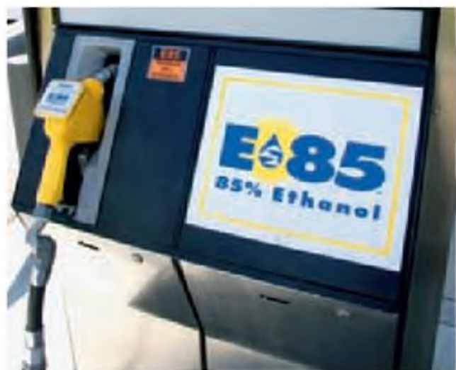
▲ Figura 1.21 Una bomba de gasolina que dispensa etanol E85.
